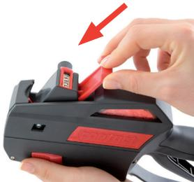
Abbildung 24 Klischee-Schieber einsetzen und einschieben
