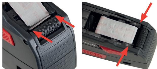
Abbildung 20 Trägerpapier hinter Führungspins
