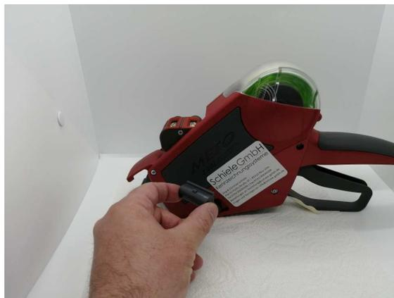
3. Schritt: Positionieren Sie die Farbrolle mittig und schließen die Frontklappe – Fertig! ✓
